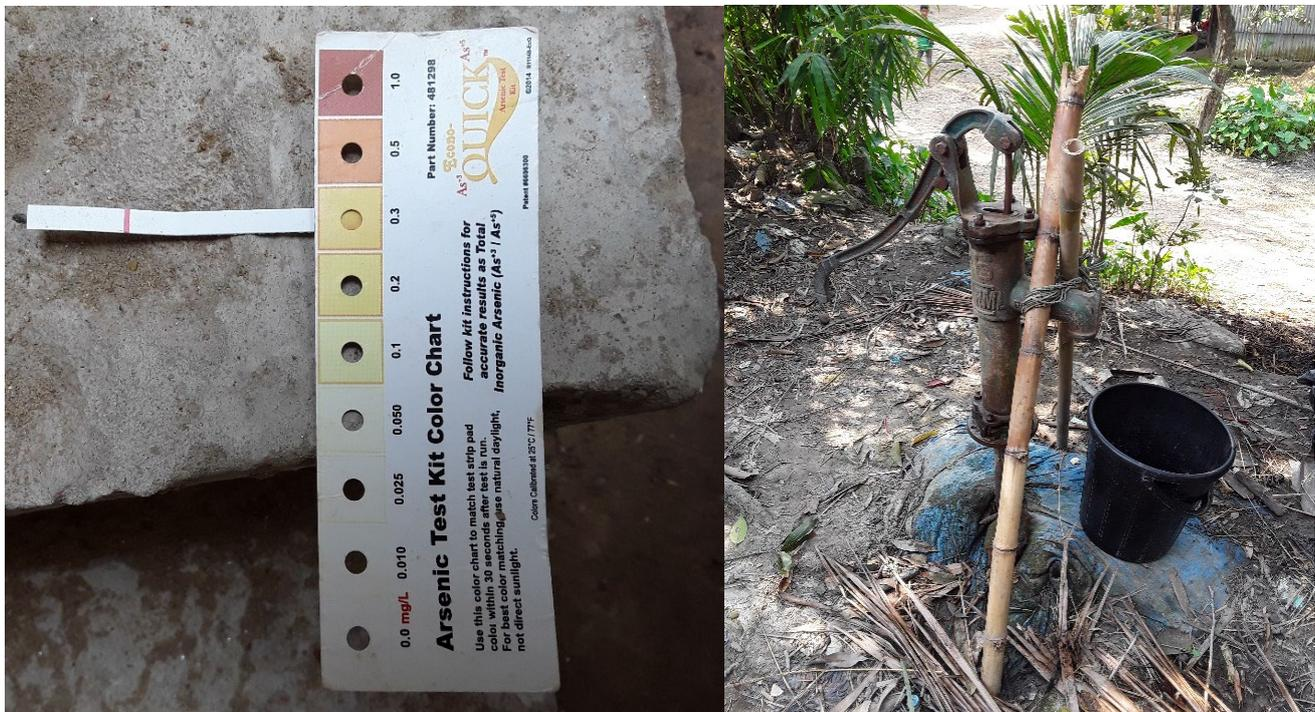
**Fotos:** Die umliegenden Haushalte der Schule haben stark arsenbelastetes Wasser (Bild links: der Schnelltest zeigt 300µg/l). Viele Brunnen sind außerdem schwergängig und in einem schlechten Zustand (Bild rechts).
